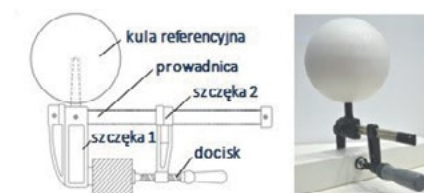
Schemat proponowanych rozwiązań z pracy pn. „Innowacyjne rozwiązania do stabilizacji kul referencyjnych na powierzchni terenu oraz balustradach i poręczach”; kierownik pracy: dr inż. Maria Makuch
