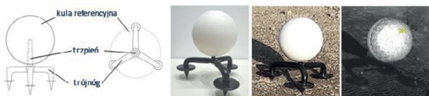
Schemat proponowanych rozwiązań z pracy pn. „Innowacyjne rozwiązania do stabilizacji kul referencyjnych na powierzchni terenu oraz balustradach i poręczach”; kierownik pracy: dr inż. Maria Makuch
