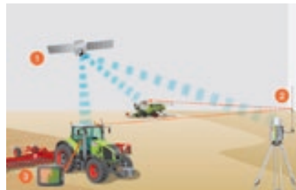
Zasada konfiguracji sygnału wyjściowego kierowanego przez systemy satelitarne GPS, GLONASS i GALILEO (1) oraz sygnałów korekcyjnych od EGNOS do RTK i GSM (2) do multipleksera (3) i sterownika współpracującego z układem kierowniczym pojazdu.
