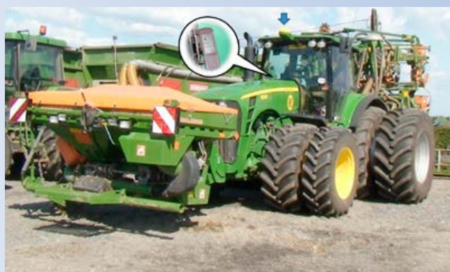
Zestaw: ciągnik-siewnik sterowany przy wykorzystaniu systemu AutoTrac (strzałka wskazuje fabrycznie montowany odbiornik sygnału satelitarne)
