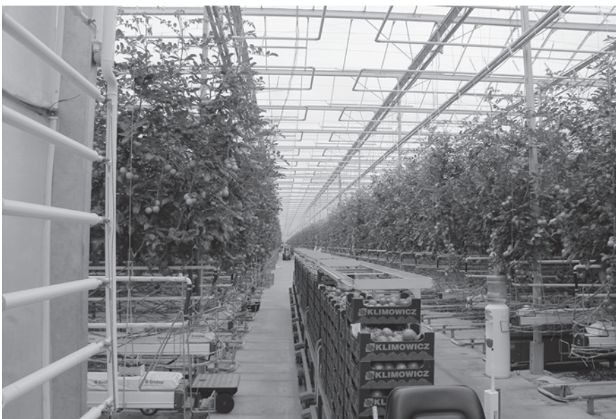
Proces transportu pomidorów jest całkowicie zautomatyzowany – wózki poruszają się same, bez kierowcy
